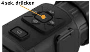
Drücken Sie den Menu-Knopf **(4)** kurz um die Parameter der aktuellen Optionen anzupassen. Drücken Sie die Taste E-Zoom **(5)** oder Photo **(2)** Taste. Damit wird der aktive Menüpunkt nach unten oder nach oben geschoben und sie können das gewünschte Menü auswählen. Halten Sie die Menükнопf **(4)** 3 Sekunden lang gedrückt, um die erweiterte Menüoberfläche wieder zu verlassen.
