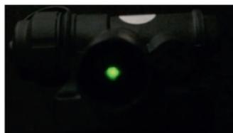
Leuchtende LED Indikator zeigt, dass das Nachtsichtgerät eingeschaltet ist.
