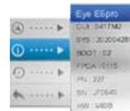
**Werksrückstellungen:** Drücken Sie kurz auf die E-Zoom Taste, um das Gerät auf die Werksausstellungen zurückzusetzen. Drücken Sie kurz die Bildmodus-Taste oder die Kamera-Taste, um ein Ja oder Nein auszuwählen. Wenn Sie fertig sind, drücken Sie kurz die E-Zoom-Taste für eine Bestätigung. Nach dem Reboot der Werkseinstellungen wird das Bild wieder im original ausgelieferten Status gestartet.
