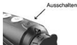
**Standby-Modus:** Wann das Gerät eingeschaltet ist, drücken kurz den power Knopf, um in den Standby-Modus zu gelangen, wobei die Kontrollleuchte blinkt. Drücken Sie erneut kurz auf den Ein/ Aus-Schalter, um das Gerät aus dem Stand-by-Modus in den Normalzustand zurückzuziehen.
