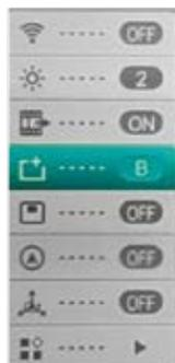
**Bild in Bild (PIP):** Wenn die Bild-in-Bild-Funktion eingeschaltet ist, erscheint oben in der Mitte ein kleines Fenster mit der 2x Vergrößerung des normales Bildes.
