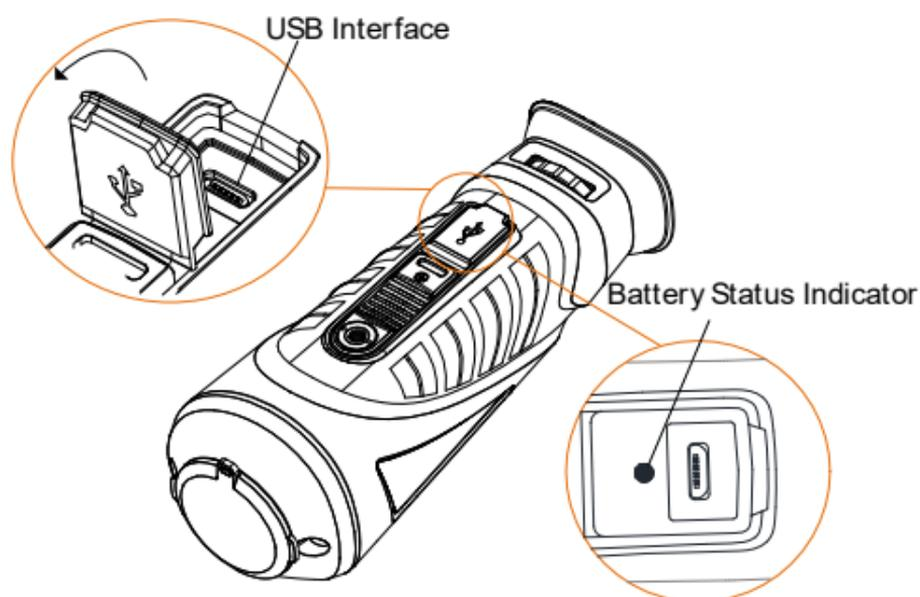
2. Schließen Sie das USB-Kabel an und verbinden Sie den anderen Anschluss mit dem Netzteil.
